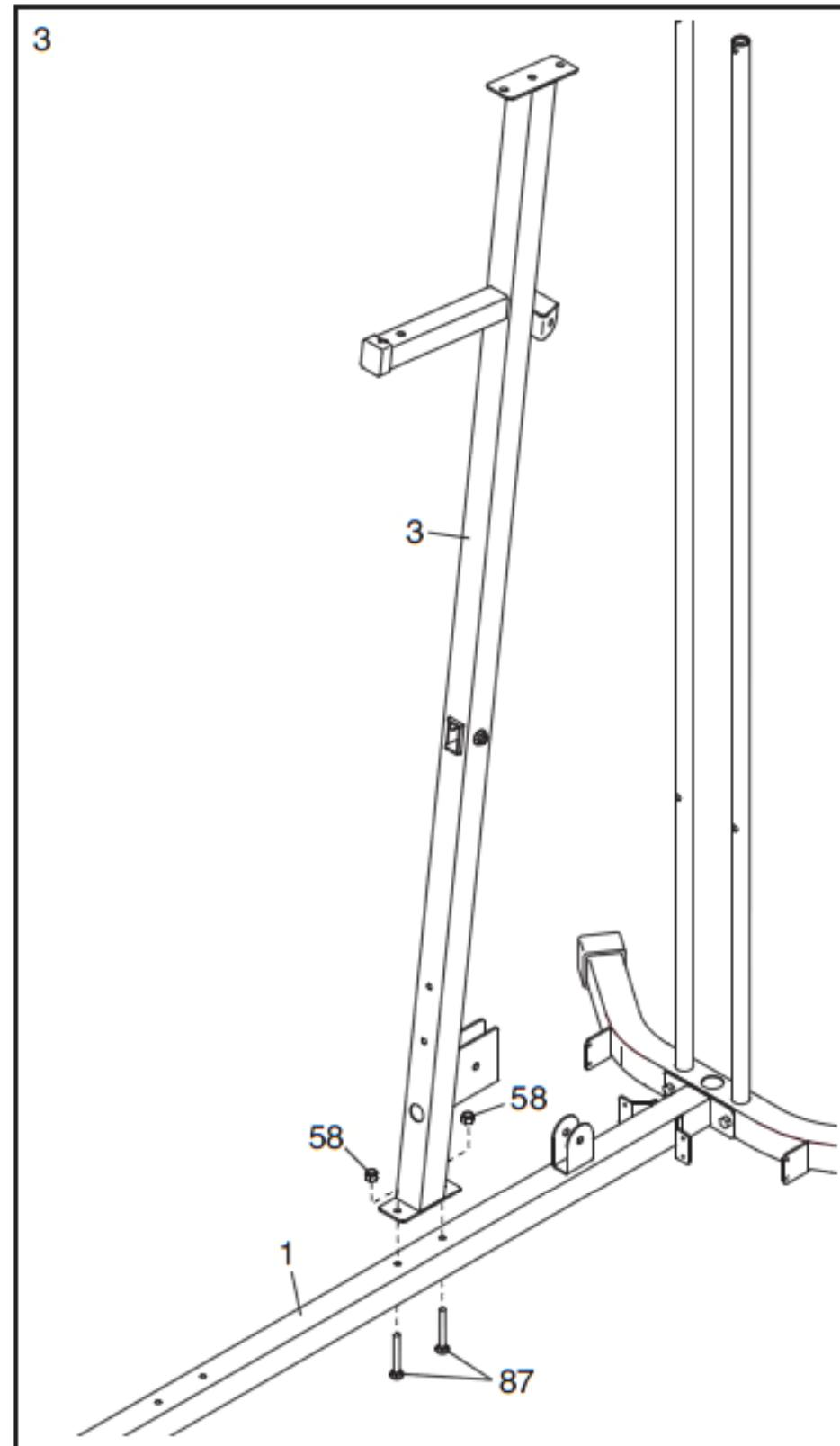
4. Такими же двумя болтами M8 x 63 мм (87) и двумя контргайками M8 (58) прикрутите к основанию (1) переднюю ножку (7). Контргайки пока не затягивайте.
