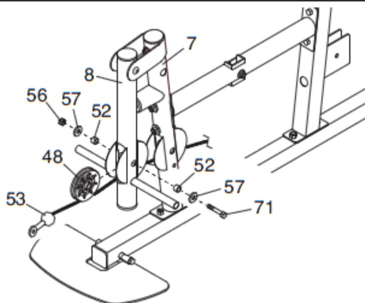
20. Вставьте толстый блок (48) в переднюю ножку (7), над нижним тросом (53), и закрепите с помощью болта M10 x 67 мм (71), двух шайб M10 (57), двух распорных втулок 13 мм (52) и контргайки M10 (56).
